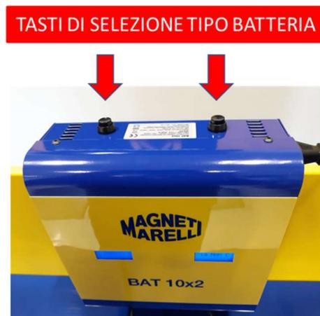
Nella **FASE DI STAND BY** è **FONDAMENTALE** fare attenzione affinché le pinze non siano poste in corto circuito o con inversione di polarità pena la rottura dell'elettronica di comando, come indicato nel manuale d'uso nella sezione SICUREZZA.
